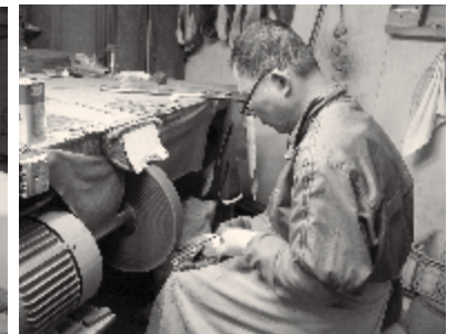
▲ 솥수저를 반짝반짝 빛나게 닦는 공정에 열중하고 있다. 이 공정을 거쳐야 오롯이 새로운 유기가 완성된다.
