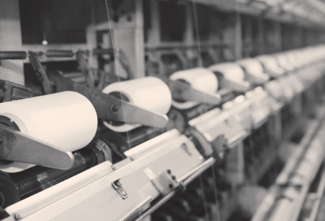
▲ ATY(Air Textured Yarn) 압축된 공기로 나일론 원사에 루프(Loop)를 형성시켜서 면(Cotton)과 유사한 핸드필을 발현시키는 공정.
