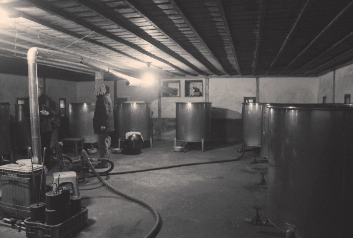
▲ 술이 익어가는 공간이다. 늘 20도 온도를 맞춰야 하는 까다로운 공간이지만 여름철에는 시원하고, 겨울철에는 따뜻한 온기를 내뿜는다. 이곳의 벽과 천장은 독특하다. 일정한 온도를 유지하기 위해 왕겨를 채워 넣은 두 겹의 벽 두께가 무려 1m 가까이 된다.
