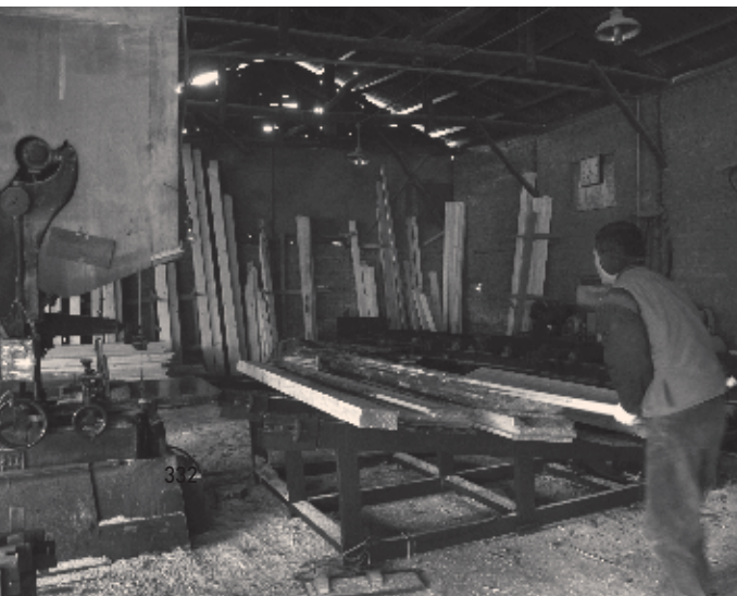
◀ 원목을 잘라 규격에 맞게 다듬는 작업이다. 이렇게 다듬은 후에 나무가 틀어지지 않게 56°를 오가는 건조기에서 몸을 익혀 새롭게 거듭난다.
