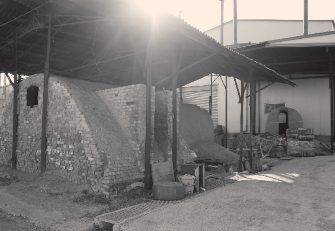
▲ 두꺼비 가마. 200여 평 넓은 공간에서 손으로 직접 기와를 만들고, 옛날 방식의 두꺼비 가마 세 대를 이용해 기와를 굽고 자연햇빛을 이용해 말리는 과정을 고스란히 재현하고 있다.
